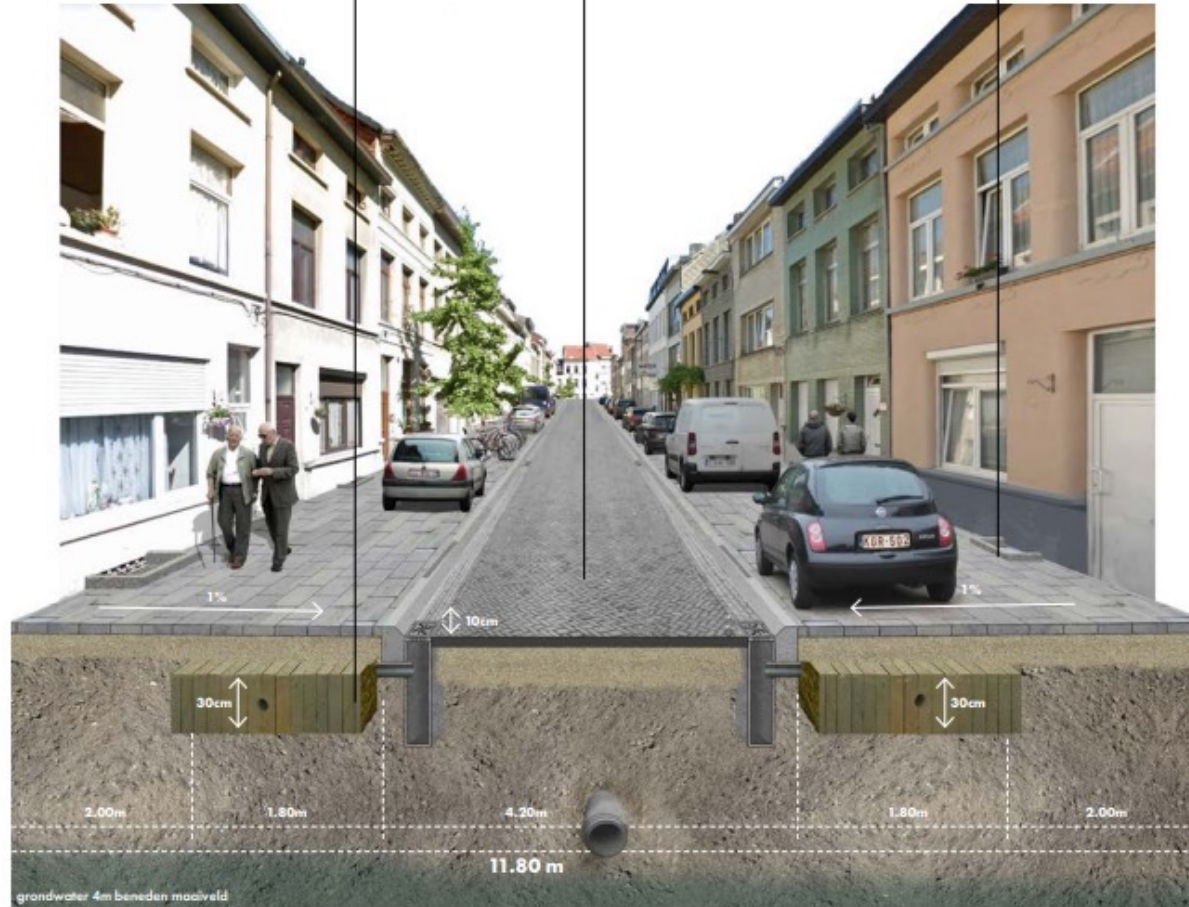
Uitgewerkte impressie technisch waterbergende straat
